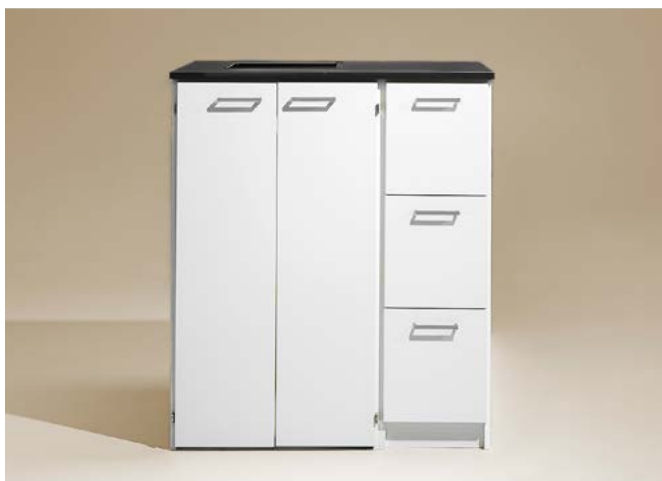
Miljöstation 1. Färdig modul (1020x1174x760 mm) med håltagning*. 350x350 mm i bänkskivan. Stationen är anpassad för 190 liters returkärl/wellvagn och 19 + 10 liters kärl. Returkärl och wellvagn ingår ej. Rostfria handtag ingår som standard.
